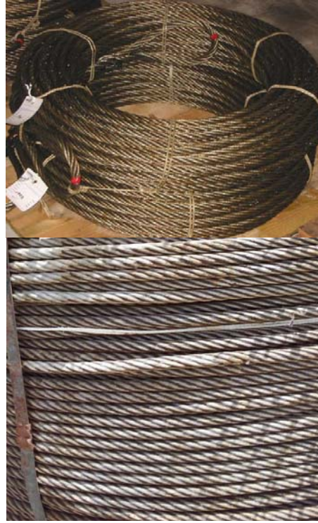
صورة رقم (10): الحبال السلكية المستعملة في صناعة معدات الصيد
