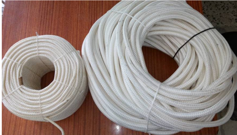
صورة رقم (9): الحبال المضفورة
